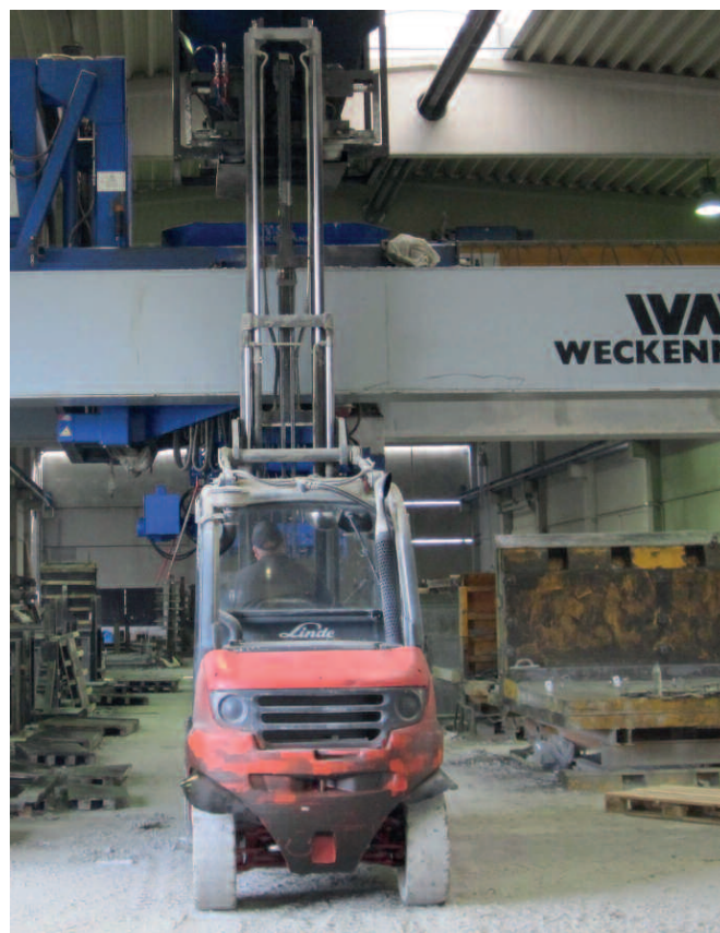
Наполнение бункера бетонораздатчика пока еще осуществляется с помощью автопогрузчика; в скором времени бетон будет поступать в бункер бетонораздатчика с новой бетоносмесительной установки по рельсовой линии.
