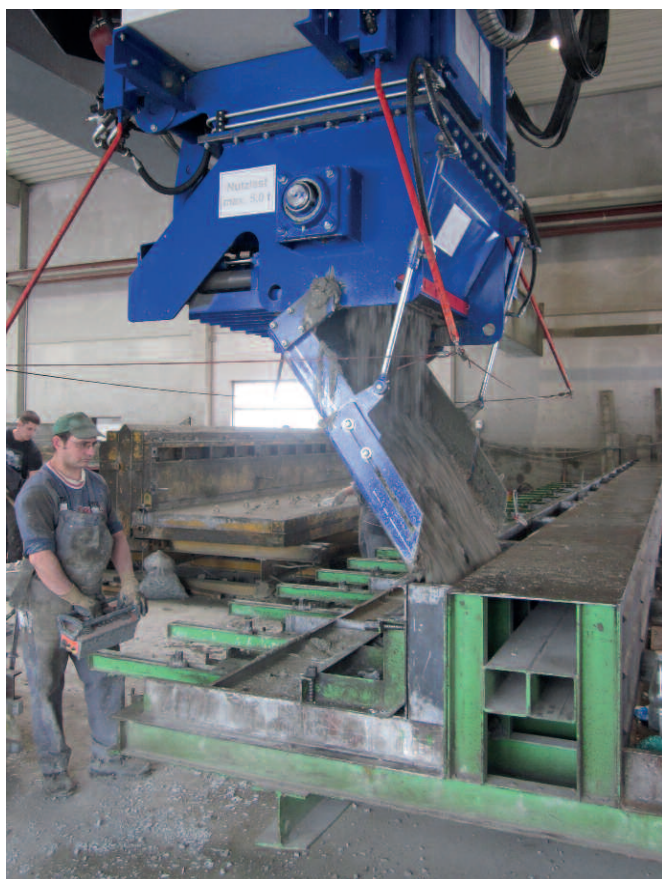
Новый бетонораздатчик подходит чрезвычайно точно к опалубкам любой высоты и управляется лишь одним оператором.
