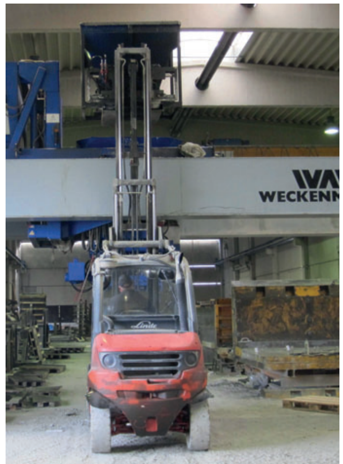
La benne du distributeur est actuellement toujours remplie à l'aide d'un chariot élévateur ; bientôt, le béton sera directement transmis d'une installation de mélange en cours de planification au distributeur de béton, via une voie secondaire.
