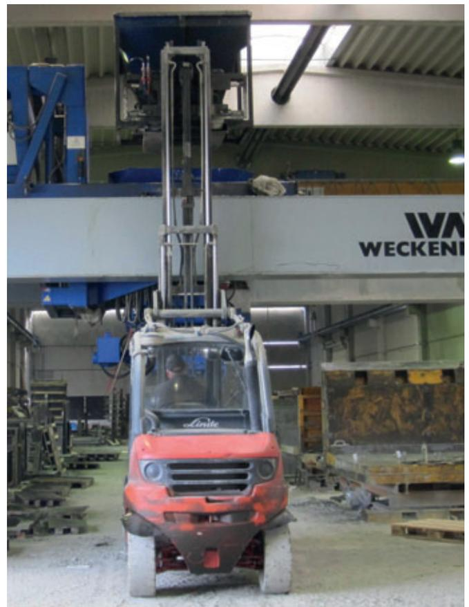
El llenado de la cuba del distribuidor de hormigón aún se realiza mediante carretilla elevadora, pero pronto el hormigón será traspasado directamente hasta el distribuidor de hormigón a través de una línea secundaria desde la instalación de mezcla, que aún se encuentra en fase de planificación.
