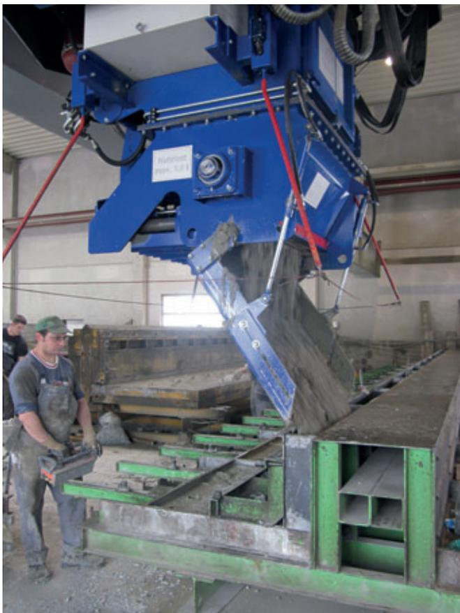
Con el nuevo distribuidor de hormigón se pueden controlar, con un solo operador, todas las alturas de encofrado de una forma extremadamente precisa y flexible.
