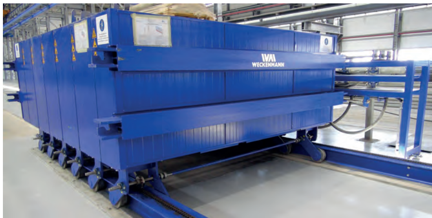
Опалубка для лестничных маршей
