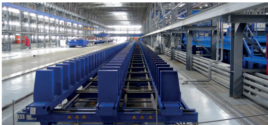
Опалубка для колонн
