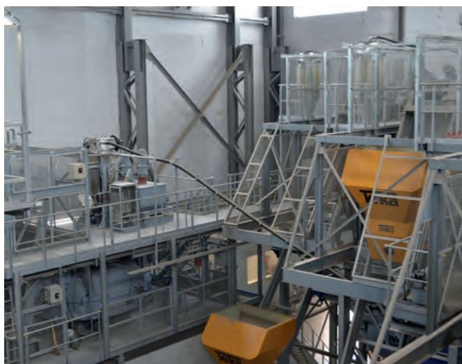
БСУ состоит из пяти автономных комплектных бетоносмесительных станций
