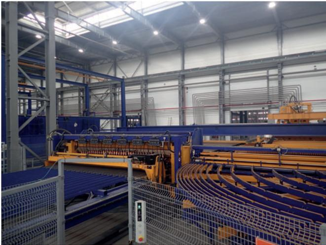
Machine de soudage de treillis HFBE/158
