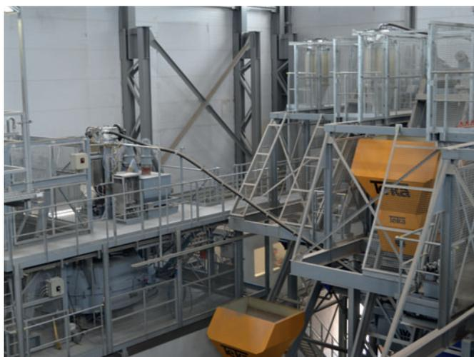
Cette installation de mélange de béton complète est constituée de cinq stations de mélange totalement autonomes et indépendantes, placées les unes à côté des autres.
