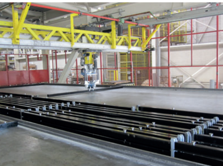
Modernización con robot de encofrado y sistemas de encofrado con imanes integrados
