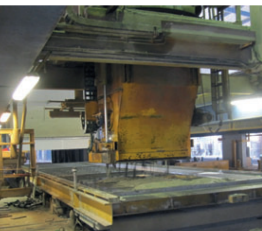
Izquierda: distribución irregular de hormigón, puesto de mando de desplazamiento paralelo. Derecha: descarga de hormigón precisa y uniforme con un nuevo distribuidor de hormigón de Weckenmann
