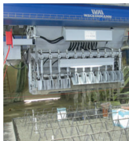
Izquierda: distribución irregular de hormigón, puesto de mando de desplazamiento paralelo. Derecha: descarga de hormigón precisa y uniforme con un nuevo distribuidor de hormigón de Weckenmann
