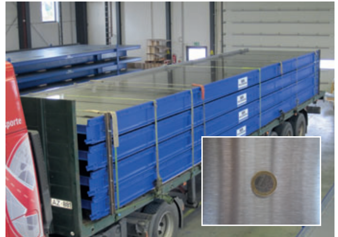
... y después del saneamiento realizado por Weckenmann: superficies vistas arenadas y pintadas y la superficie de encofrado pulida para obtener prefabricados de hormigón con una calidad elevada
