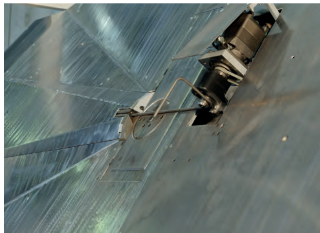
Гибочный автомат EVG Polybend PBC 2-12 с механизмом для гибки объемных арматурных элементов в трехмерном формате
