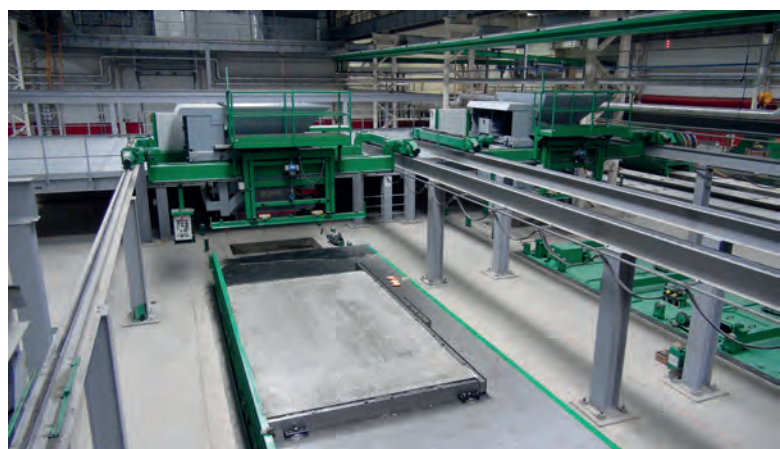
Бетонораздатчик со станцией виброуплотнения
