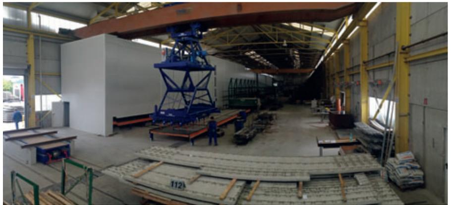
Aparelho de descarregamento com mecanismo giratório para desmoldagem e empilhamento de pré-lajes
