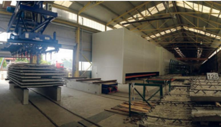
Quatro locais de empilhamento para pré-lajes com dois carros de extração em operação semi-automática
