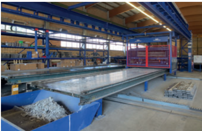
Después: A la izquierda, el nuevo equipo MRP de última generación con un nuevo sistema de control. A la derecha, el puesto de encofrado manual en forma de sistema de puesto de trabajo con carro de herramientas desplazable, pistola de pegamento, lubricador manual, así como sistema de estanterías y pasarela a lo largo de la bandeja. Pupitres de mando para el desplazamiento de las bandejas directamente junto a la estación de trabajo. Sobre la bandeja se encuentran los nuevos encofrados laterales con imanes integrados.
