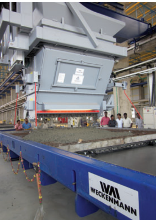
Ein Betonverteiler mit integriertem Hubwerk garantiert die punktgenaue Einbringung des Betons
