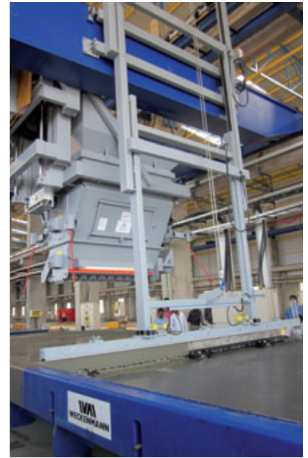
Eine höhenverstellbare Glättbohle sorgt für ausgezeichnete Oberflächenqualitäten
