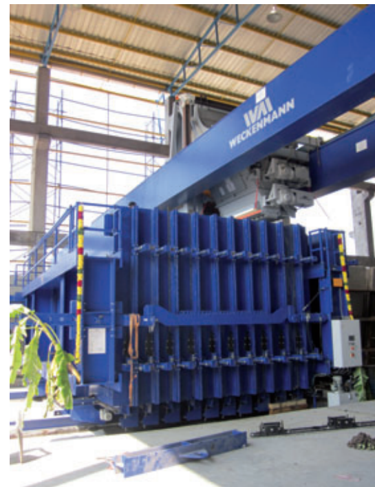
Innenwände und Begrenzungswände werden in einer Batterieschalung produziert
