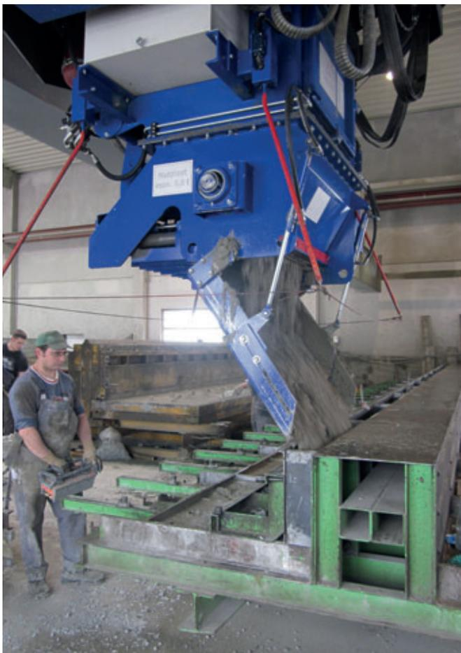
Mit dem neuen Betonverteiler können nun alle Schalungshöhen äußerst zielgenau und flexibel mit nur einem Bediener angesteuert werden.
