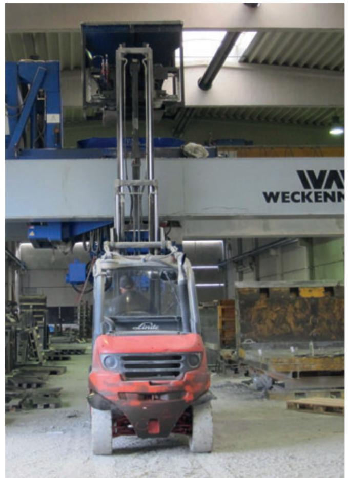
Noch erfolgt die Befüllung des Betonverteilerkübels per Stapler; in Kürze wird der Beton direkt von der derzeit in Planung befindlichen Mischanlage über eine Stichbahn in den Betonverteiler übergeben.
