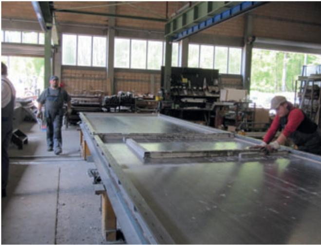
*Vorher: Schalungen und Magnete getrennt, Lagerung der Schal- und Einbauteile sowie Werkzeuge wie Klebepistole etc. stirnseitig der Palette und somit lange Wege. Manuelles Reinigen der Schalungen und Magnete.*
