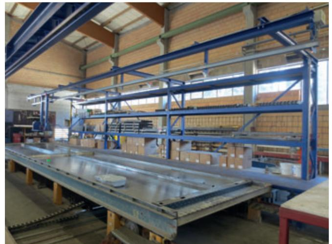
*Nachher: Links das neue MRP – Gerät auf aktuellem Stand der Technik und mit neuer Steuerung. Rechts der Handschalplatz in Form des Arbeitsplatzsystems mit fahrbarem Werkzeugwagen, Heißklebepistole, Handöler sowie Regalsystem und Laufsteg entlang der Palette. Bedienpulte zur Palettenverfahrung direkt bei der Arbeitsstation. Auf der Palette befinden sich die neuen Abschalungen mit integrierten Magneten.*
