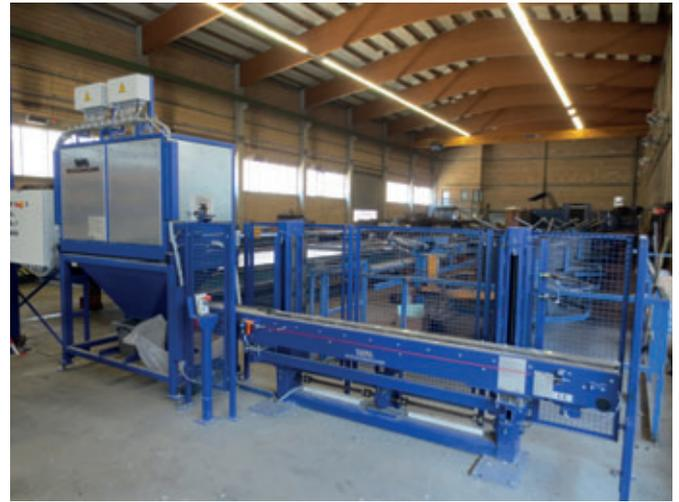
*Nachher: Schalungstransportsystem mit Reiniger – Öler für Abschalungen mit integrierten Magneten. Automatisches Reinigen – Ölen der Abschalungen und Transport der Abschalungen vom Ausschlagplatz direkt zum Einschlagplatz.*
