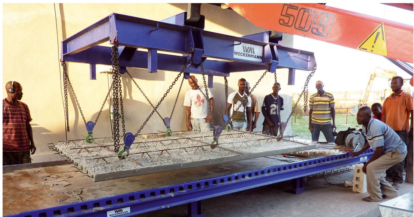
Auf einem stationären Fertigungstisch werden Elementdecken produziert. (Bild: www.pro-haiti.de)
