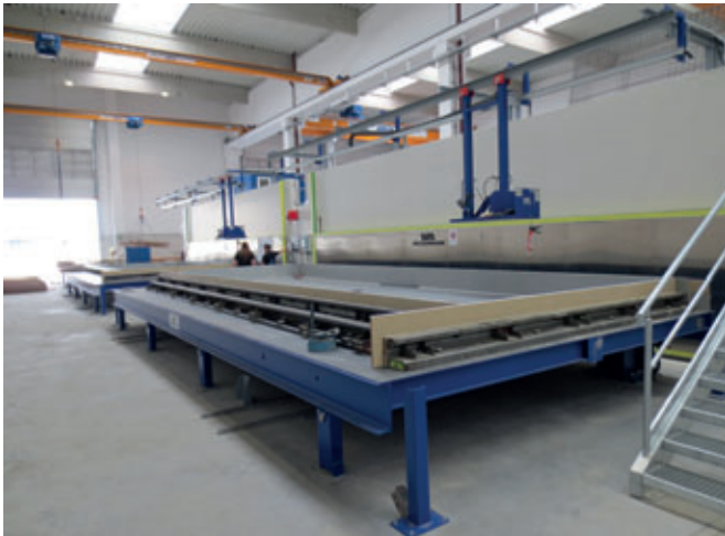
Einschalstationen mit Projektionslaser
