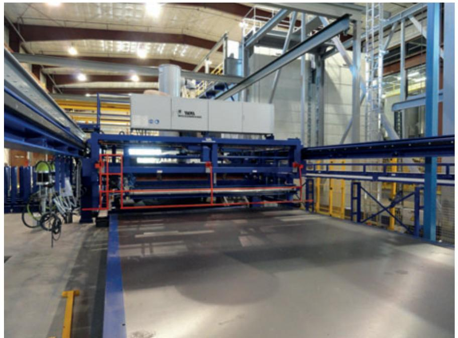
An der RPÖ- (Reinigen, Plotten, Ölen) Station werden die Plattenabmessungen und Positionen für Einbauteile aus einer CAD-Datei auf den automatischen Plotter heruntergeladen und direkt auf die saubere Palette übertragen.
