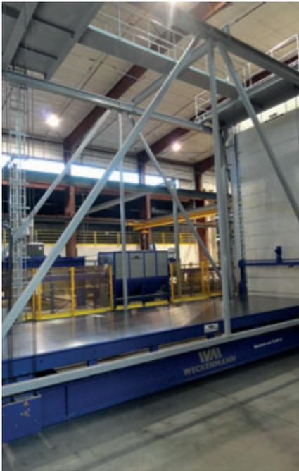
Die Härtekammer kann in einem Regal-system 18 Paletten aufnehmen. Nach 1-2 Stunden Vorhärten in der Härtekammer wird die Palette herausgezogen und mit einem automatischen Regalbediengerät oben auf die Kammer gehoben.
