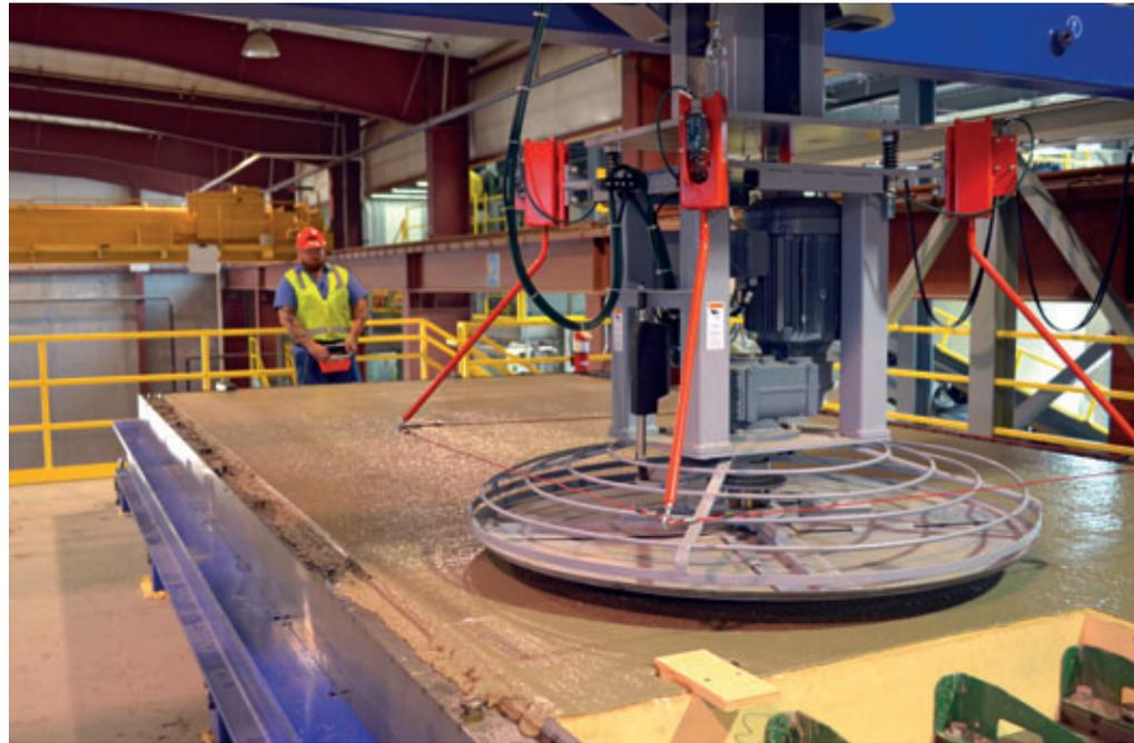
Nachdem eine Palette in der Härtekammer zu erstarren begonnen hat, wird sie zu der Glättstation transportiert. Diese ist oberhalb der Kammer angeordnet, um im Werk Platz zu sparen. Ein Mitarbeiter bedient mit einer Fernsteuerung den Flügelglätter, der mehrere Arbeiter einer traditionellen Anlage ersetzt.
