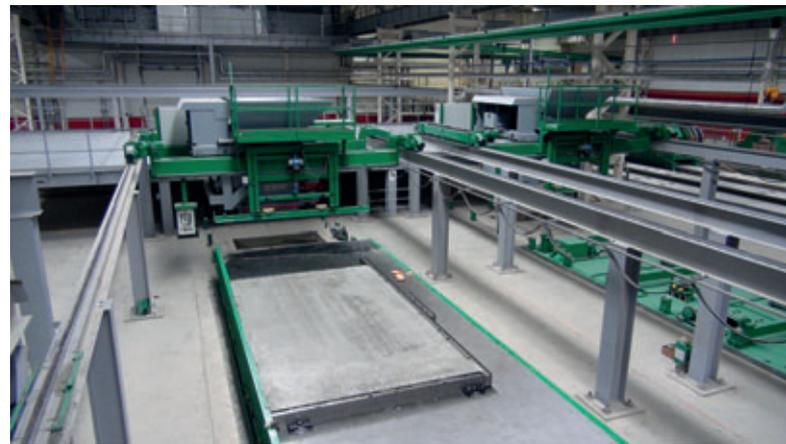
*Betonverteiler mit Verdichtungsstation*
