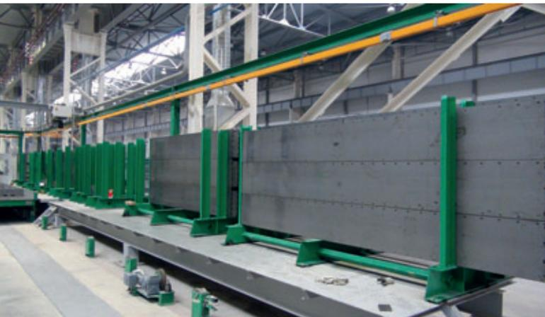
*Schalungslager der Weckenmann Schalungsprofil M-Serie*
