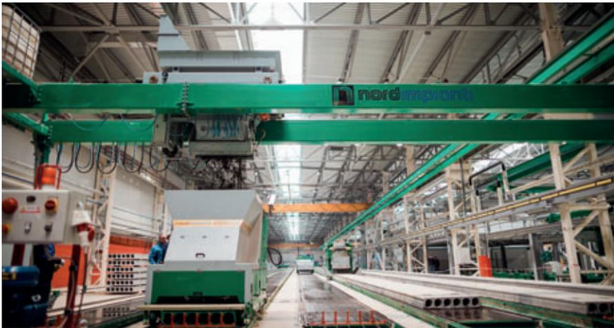
Spannbetonfertigdeckenfertigung von Nordimpianti
