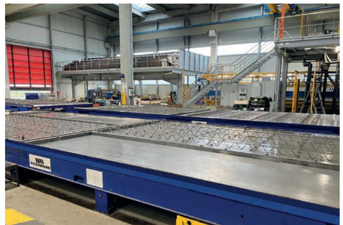
*Paletas de Weckenmann (60 paletas en el volumen de suministro, de ellas 12 paletas tienen una altura de encofrado del borde de 60 mm y 48 paletas con una altura de encofrado del borde de 70 mm). Colocación de la armadura y paletas de encofrado de accesorios con encofrados A e imanes integrados*
