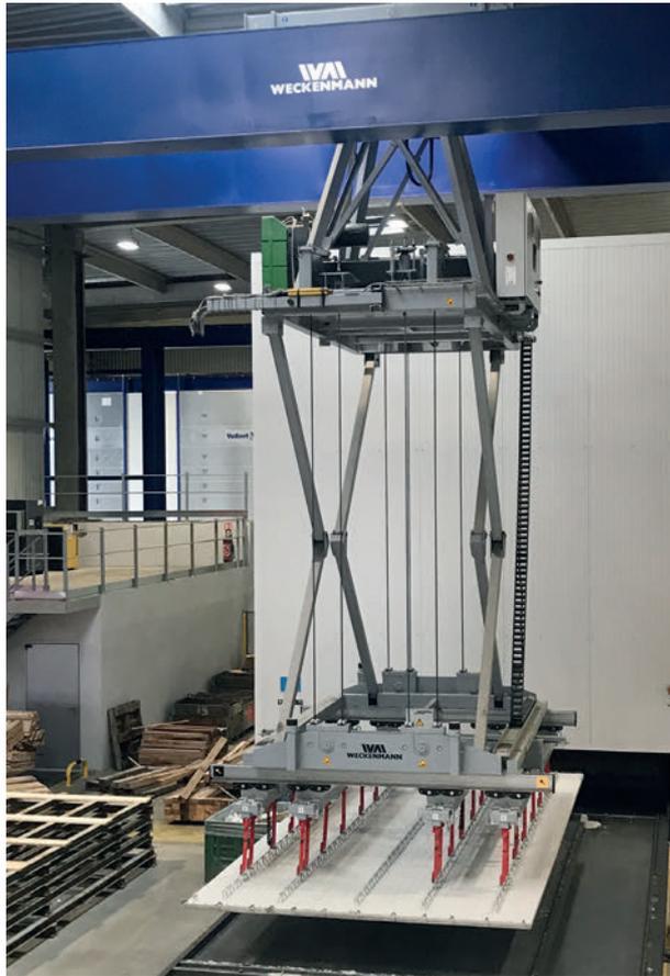
*Aparato de elevación para placas de forjado de Weckenmann*
