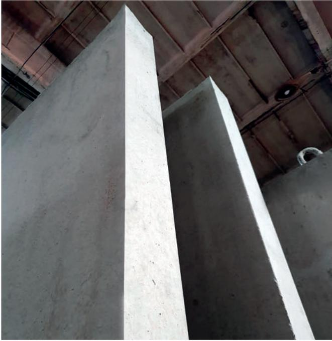
*Weckenmann desarrolló para el cliente una variante semimóvil del encofrado de batería con una mayor estabilidad, con el que se pueden fabricar todos los elementos de una casa multifamiliar prefabricada en un único encofrado de batería, incluidas las placas del suelo macizas con un espesor de 180-200 mm*
