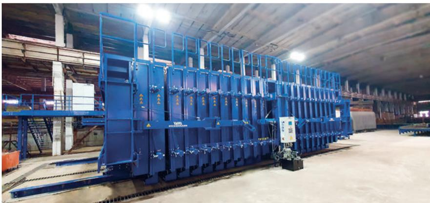
*El encofrado de batería cubre la completa gama de productos de Tetra con prefabricados de diferente tamaño*
