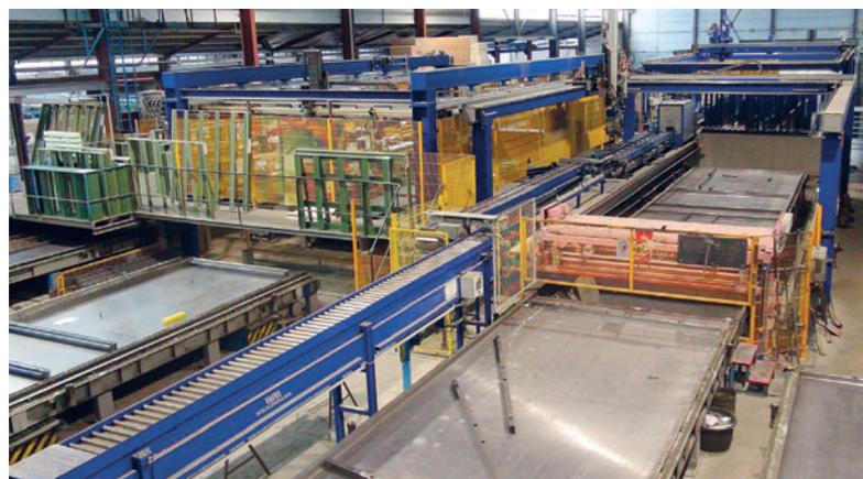
Рис. 2. Общая система с механизмом перемещения магнитных блоков, опалубочным / распалубочным роботом (в одном положении), устройством очистки поддонов и опалубки, роботом-накопителем и встроенным роботом для установки закладных деталей
