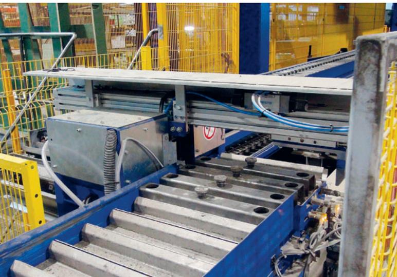
Рис. 3. Узел смазки магнитных блоков
