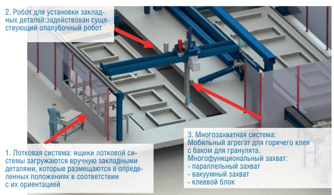
Рис. 6. Описание системы захвата (горизонтальная проекция)
