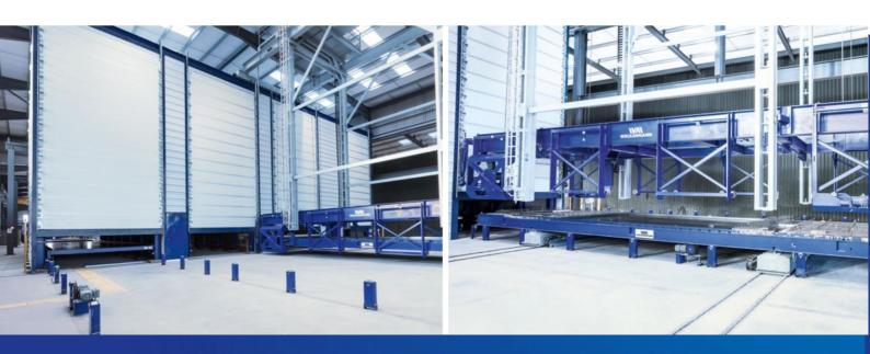
КАМЕРА СУШКИ служит для теплоизолированного, контролируемого и компактного отверждения бетонных элементов. При необходимости этот процесс также может быть ускорен посредством интегрированной системы обогрева, климат контроля и влажности.
