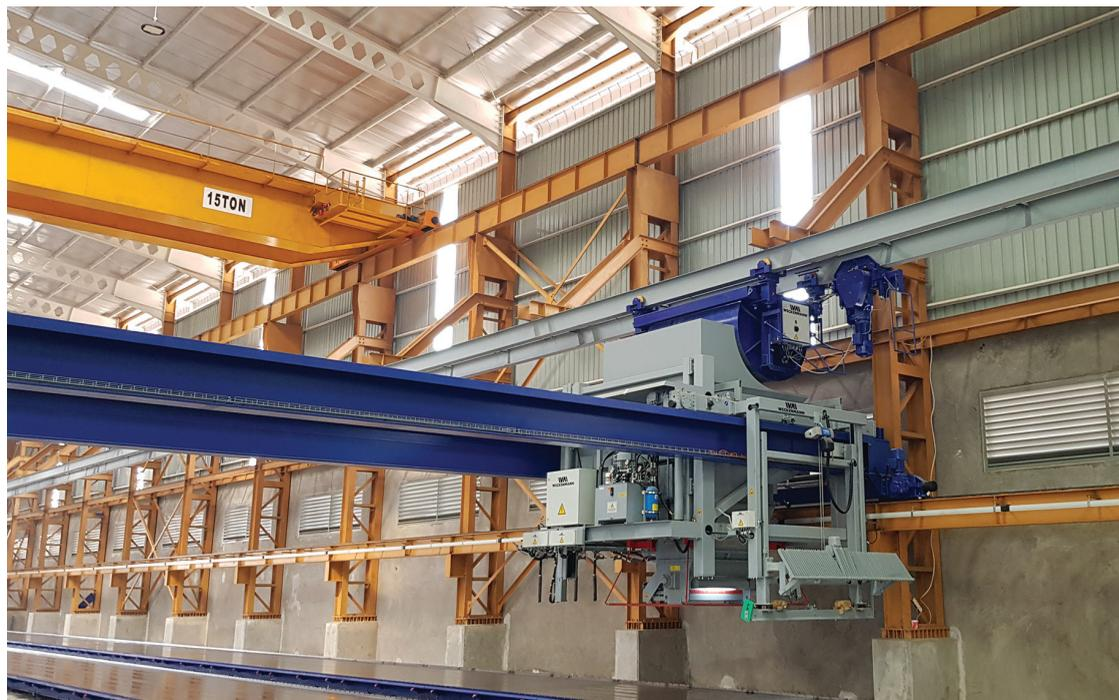
Полупортальный бетонораздатчик с адресной подачей при приеме бетона
