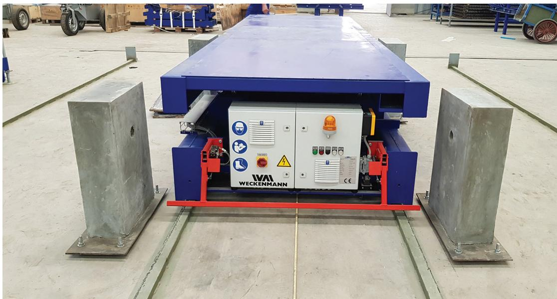
Вывозная тележка с поднимаемой при помощи гидравлики платформой для приема штабелей плит перекрытия
