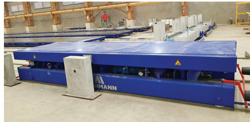
Вывозная тележка с поднимаемой при помощи гидравлики платформой для приема штабелей плит перекрытия
