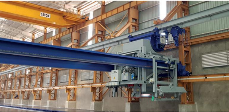
*Distribuidor de hormigón tipo semipórtico con cuba aérea durante la recepción de hormigón*
