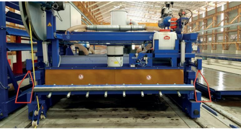
*Sistema de limpieza y pulverización de agente desenfrente con barra de tracción para cordones de pretensado*
