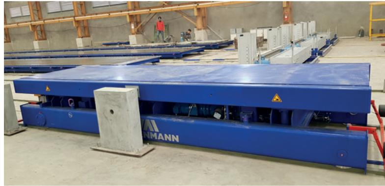
*Carro de salida con plataforma de elevación hidráulica para cargar las pilas de losas*
