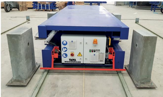
*Carro de salida con plataforma de elevación hidráulica para cargar las pilas de losas*
