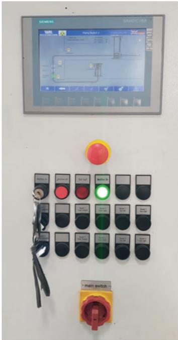
*Puesto de mando del control de comunicación para la solicitud de hormigón con visualización del proceso*
