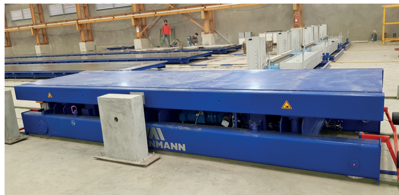
Разгрузочная тележка с гидравлической подъемной платформой для передачи штабеля перекрытий
