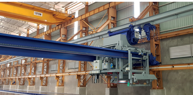
Полупортальный бетонораздатчик с линией адресной подачи бетонной смеси
