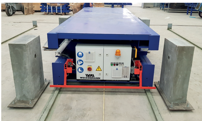
Разгрузочная тележка с гидравлической подъемной платформой для передачи штабеля перекрытий
