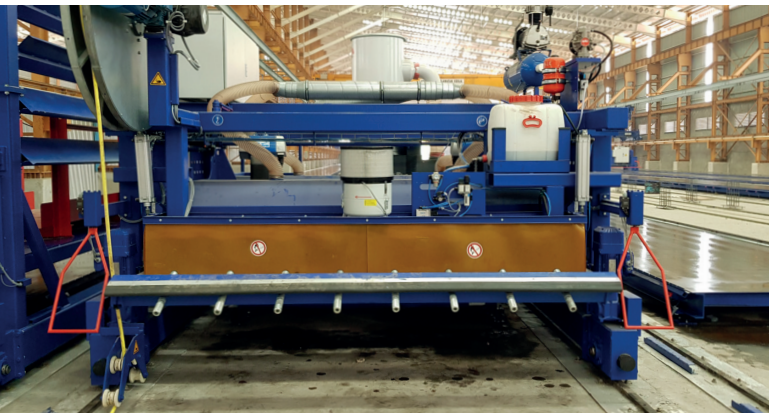
Установка для очистки и распыления разделительной смазки с вытяжной рейкой для натяжной арматуры
