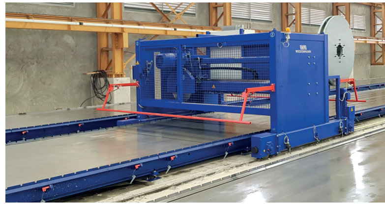
Распиловочная установка для натяжной арматуры
