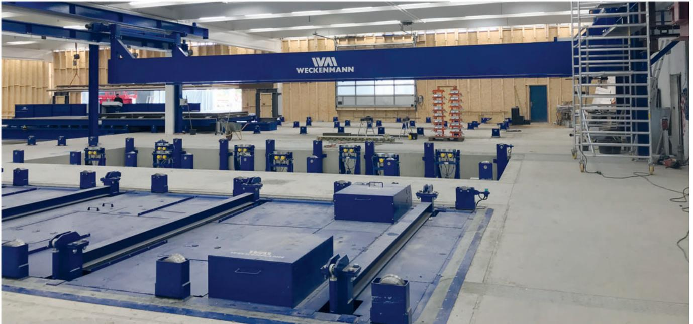
*Estação vibratória Weckenmann e técnica de vibração MagVib*
