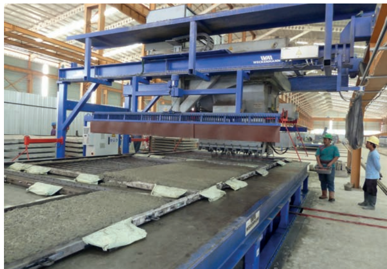
Бетонораздатчик в действии
