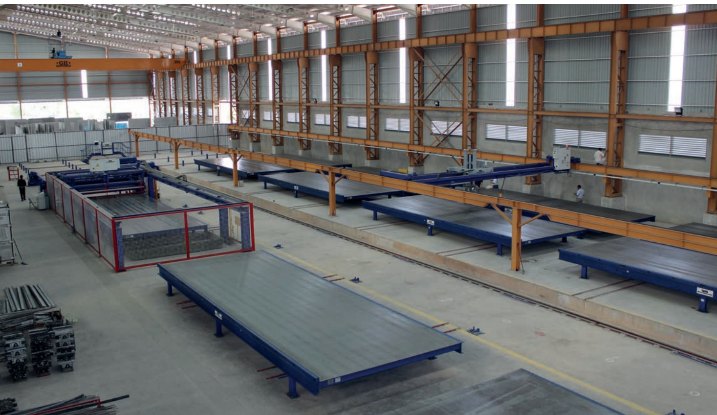
Линия оборотных поддонов с центральной сдвижной платформой
