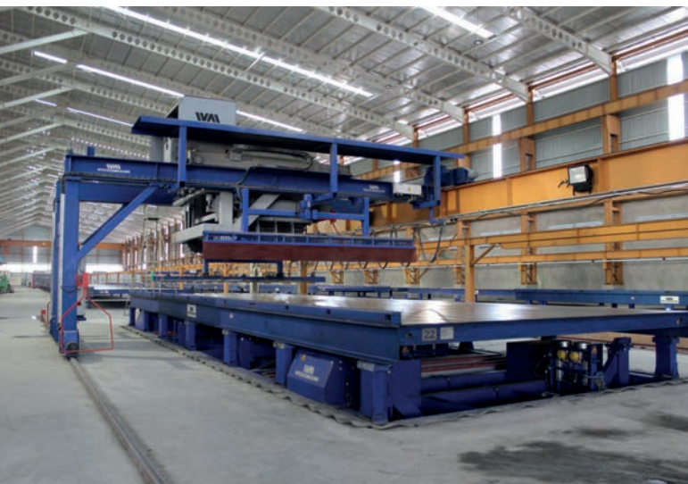
Бетонораздатчик в полупортальном конструктивном исполнении с опалубочным поддоном и станцией виброуплотнения
