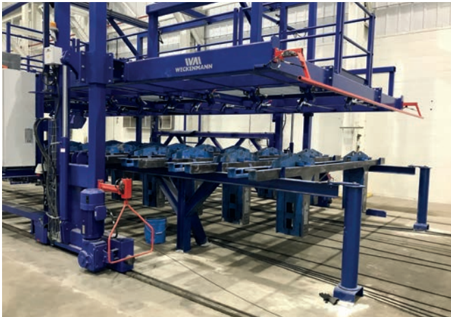
实用车 (钢绞线穿束和堵头放置)
