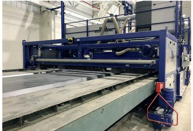
Установка для очистки, смазки и нанесения контуров
