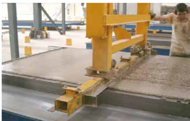
Опалубка серии М также позволяет производить выравнивание поверхности изделия машинным способом.
