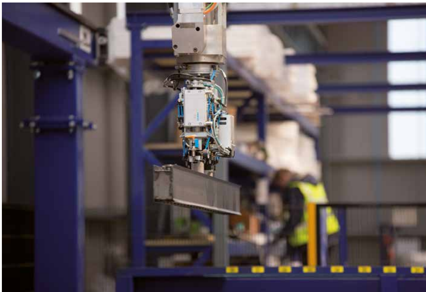
Работа опалубочного робота с бортами серии М с фаской.
