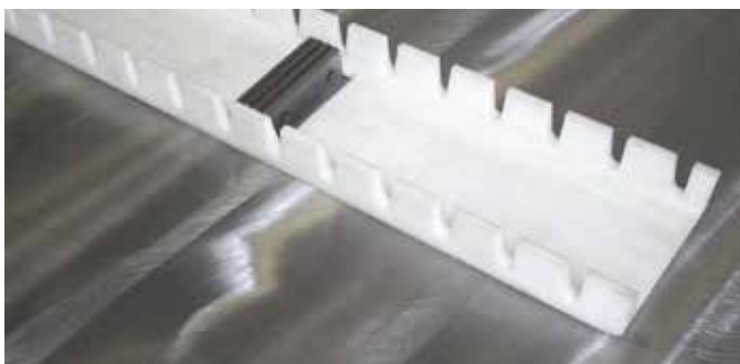
Фиксация прямой арматуры с помощью магнита
