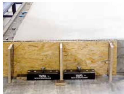
Возможно использование магнитных боксов в качестве подпорных элементов
