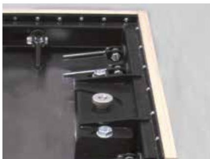
Для крепления опалубочных систем Weckenmann
