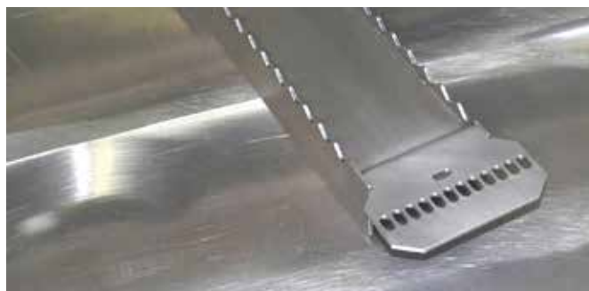
Фиксация изогнутой арматуры с помощью растровой пластины
