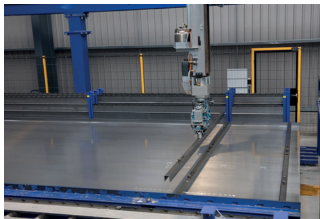
Robot de encofrado en Keegan Precast Ltd.
