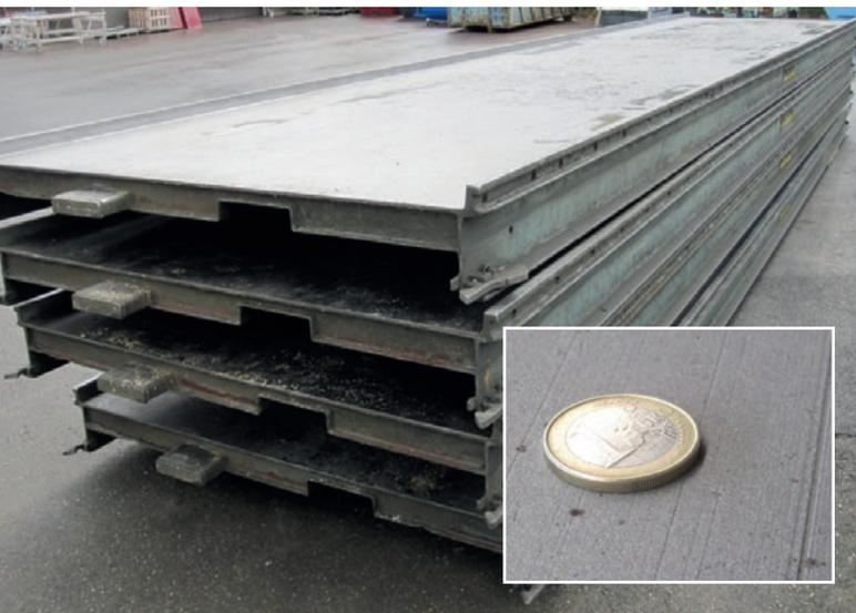
*Nach der Sanierung: geschlossene, geschliffene und eben gerichtete Schalfläche wie neu; Lackierung komplett überarbeitet und wie neu*
