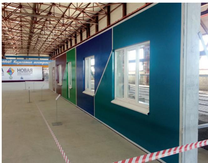
Fix und fertig zur Montage auf der Baustelle: Betonfertigteil-Seitenwände mit bereits fertig eingebauten Fenstern
