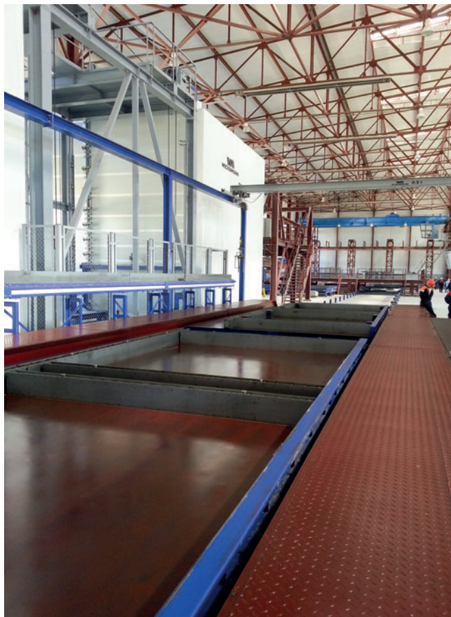
Le nouveau carrousel à palettes pour éléments préfabriqués en béton érigé par Weckenmann au Kazakhstan a été généreusement dimensionné.
