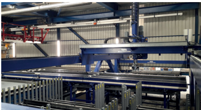
O novo robô carregador Weckenmann com o carregador alargado e os novos transportadores de rolos apalpadores
