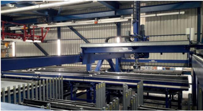
*Nouveau robot magasinier Weckenmann avec la zone de stockage agrandie et les nouveaux convoyeurs de transport à rouleaux*
