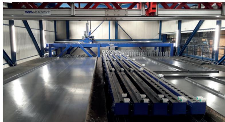
Après la modernisation : Installation de coffrage avec nouveaux convoyeurs de transport à rouleaux et nouveau robot magasinier Weckenmann
