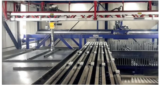
*Les coffrages provenant du magasin sont acheminés vers le robot de coffrage par le biais des nouveaux convoyeurs à rouleaux.*
