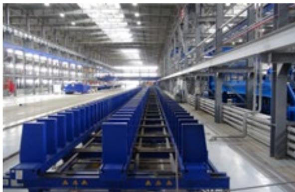
Участок стационарного производства оснащен опалубкой для изготовления опорных элементов, ...
