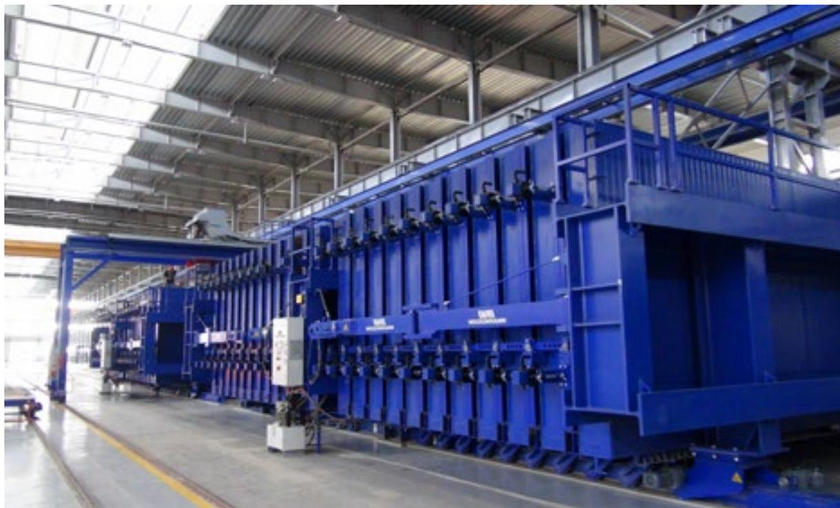
В трех кассетных опалубочных формах новейшего поколения производится до 1500 м<sup>2</sup> сборных бетонных элементов в сутки
