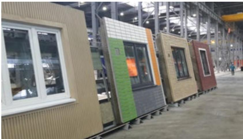
Готовые бетонные элементы, разнообразные по цвету и структуре поверхности
