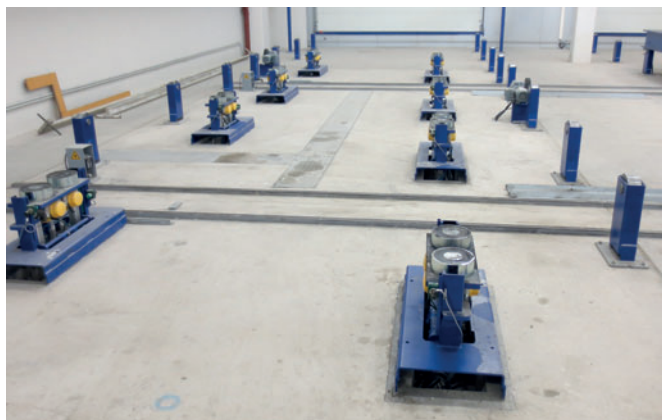
Vibradores de alta frequência equipados com ímãs em uma estação de adensamento MagVib.
