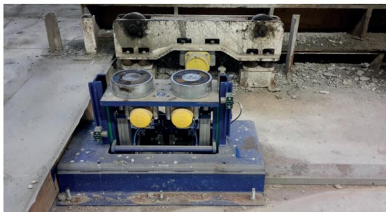
Unidad de vibración de alta frecuencia MagVib (azul), al fondo el soporte vibrador utilizado hasta entonces.
