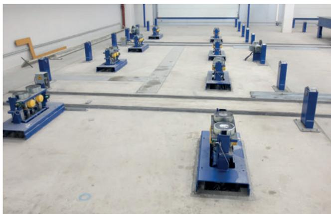
Vibradores de alta frecuencia equipados con imanes en una estación de compactación MagVib.
