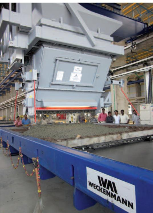
Бетонораздатчик со встроенным подъемным механизмом гарантирует точное и равномерное распределение бетона
