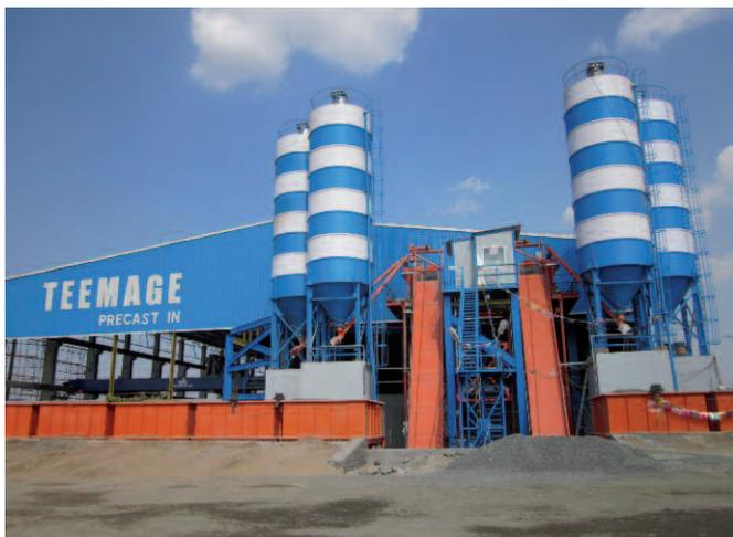
БСУ на заводе Teemage Precast состоит из двух смесителей емкостью 1,5 м<sup>3</sup> каждый и перерабатывает до 90 м<sup>3</sup>/ч бетонной смеси, которая может использоваться для производства сборных ЖБИ или как товарный бетон
