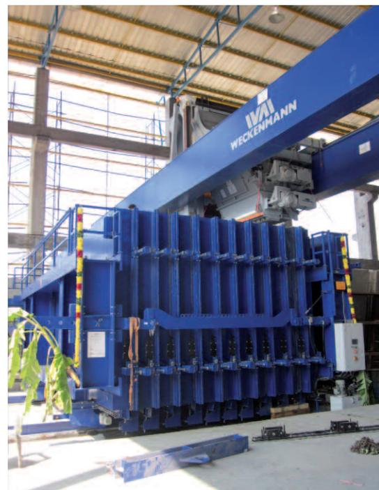
Стеновые панели изготавливаются в кассетной опалубке
