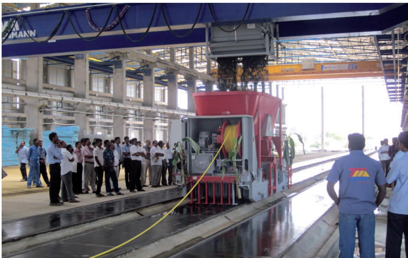
К слипформеру для производства плит перекрытия идет непрерывная автоматическая подача бетона
