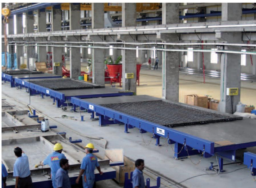
Четыре кантовательных стола размером 4,5 м x 12,5 м из упрочненной листовой стали, обеспечивающей оптимальную поверхность изделия
