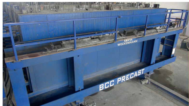
Eine der beiden Batterieschalungen für die Innen- und Außenwände
